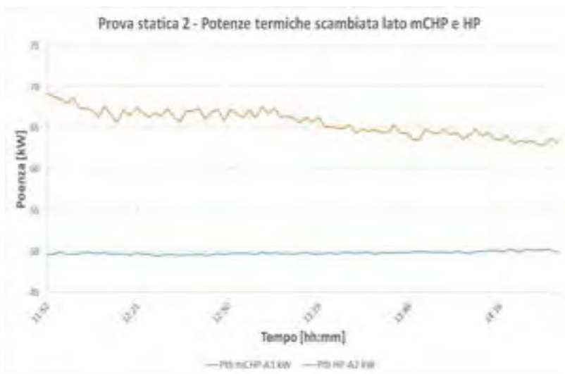
Figura 36 - Prova statica 2: Potenze termiche lato mCHP e HP
