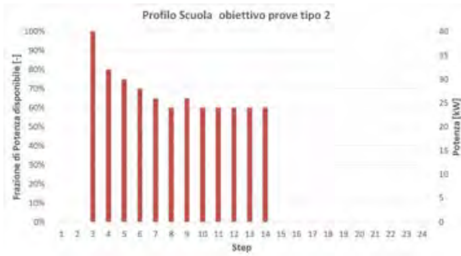
Figura 24 - Profilo di carico termico obiettivo prova 2.1 e 2.2
