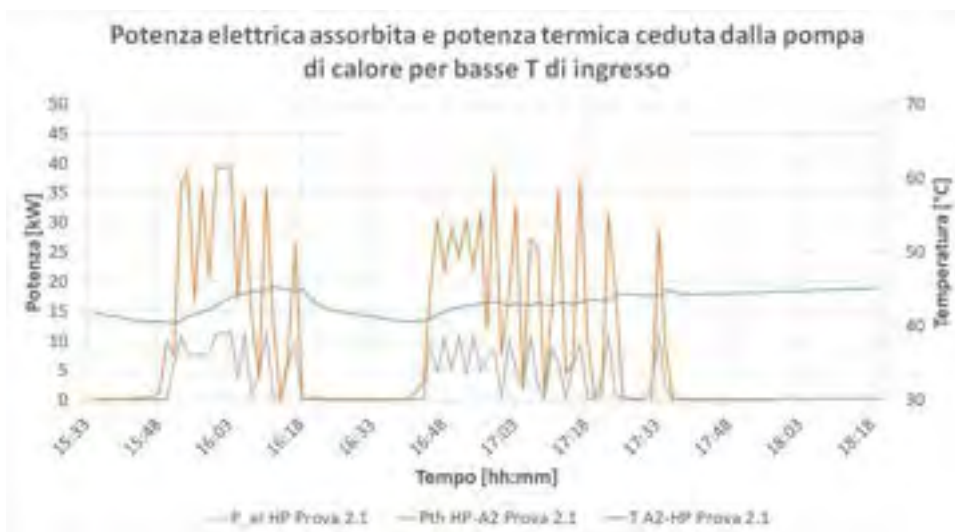
Figura 100 - Potenza elettrica assorbita e potenza termica ceduta dalla pompa di calore nella prova 2.1
