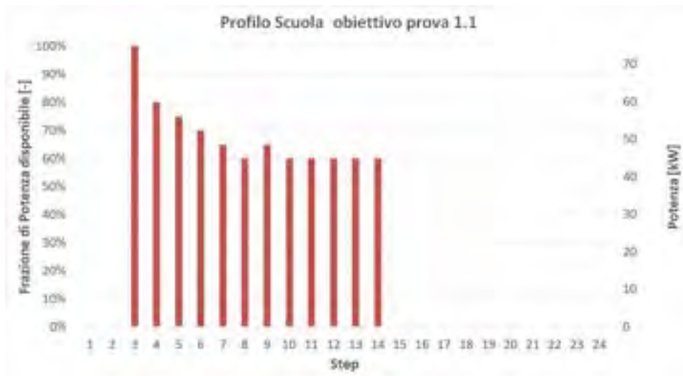
Figura 22 - Profilo di carico termico obiettivo prova 1.1
