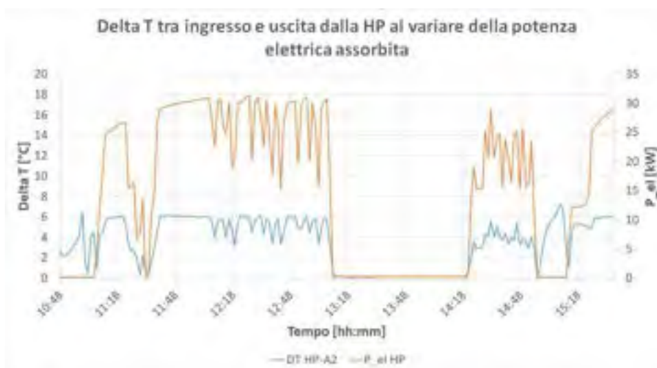
Figura 103 - Andamento del \Delta T tra A2 e HP al variare della potenza elettrica assorbita dalla pompa di calore nella prova 4
