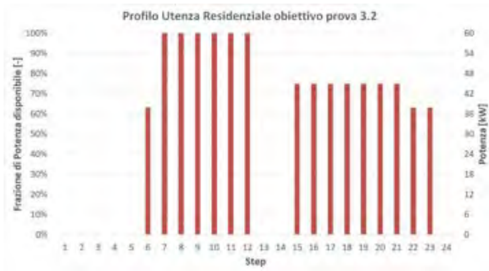
Figura 26 - Profilo di carico termico obiettivo prova 3.2
