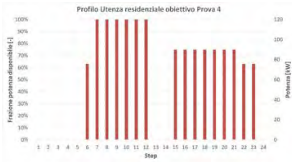
Figura 27 - Profilo di carico termico obiettivo prova 4
