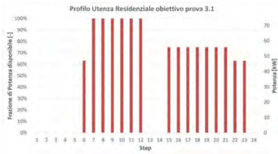
Figura 25 - Profilo di carico termico obiettivo prova 3.1
