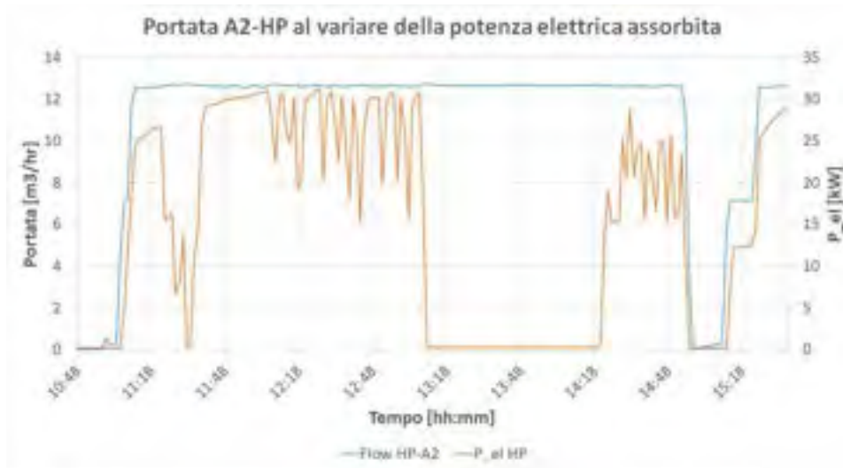
Figura 102 - Andamento della portata tra A2 e HP al variare della potenza elettrica assorbita dalla pompa di calore nella prova 4
