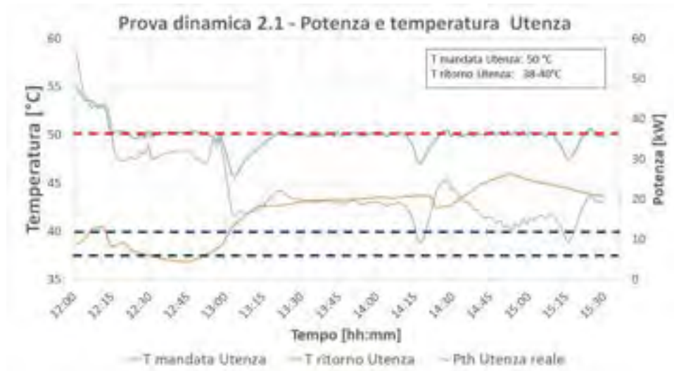
Figura 60 - Prova 2.1: Temperature e Potenza scambiata lato Utenza
