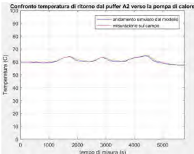
Figura 71: Confronto temperatura di ritorno dal puffer A2 verso la pompa di calore simulazione del solo accumulo A2
