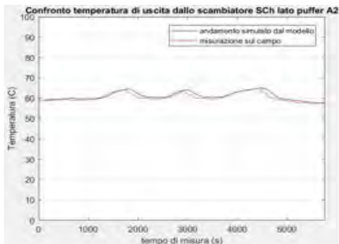
Figura 91: Confronto temperatura T_{ritSCh} simulazione accumuli A1, A2 collegati ai rispettivi scambiatori
