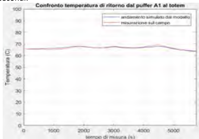
Figura 109: Confronto Temperatura ingresso Totem 25 prova ST08
