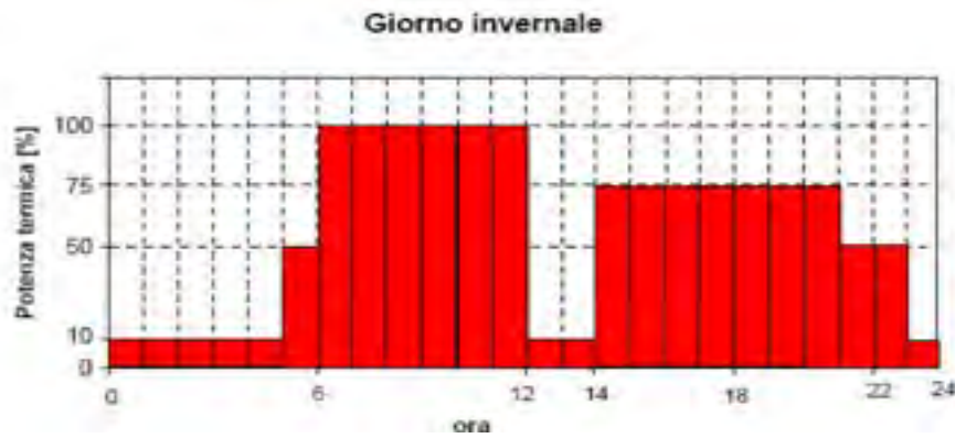
Figura 30: Profilo di carico termico generico invernale
