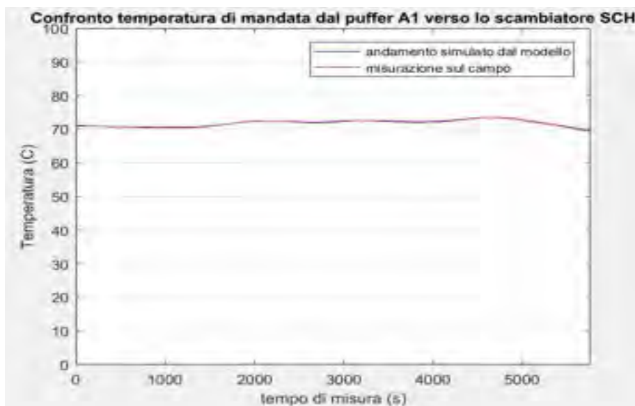
Figura 67: Confronto temperatura di mandata verso lo scambiatore SCH lato puffer A1 simulazione del solo accumulo A1
