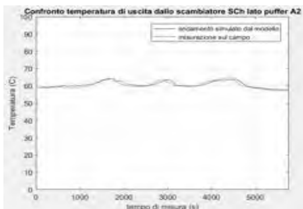
Figura 112: Confronto Temperatura di ritorno dallo scambiatore SCH prova ST08
