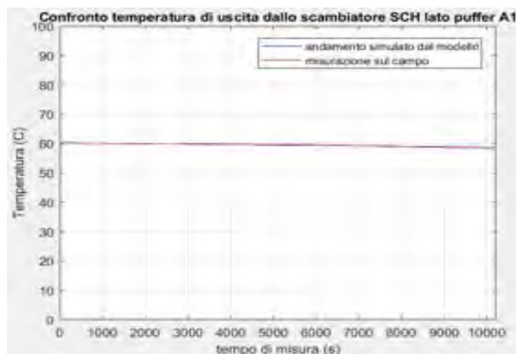
Figura 105: Confronto Temperatura di ritorno dallo scambiatore SCH prova ST08
