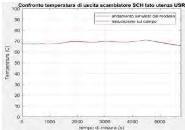
Figura 78: Confronto della temperatura T_{in\ USR} simulazione accumulo A1 con scambiatore SCH
