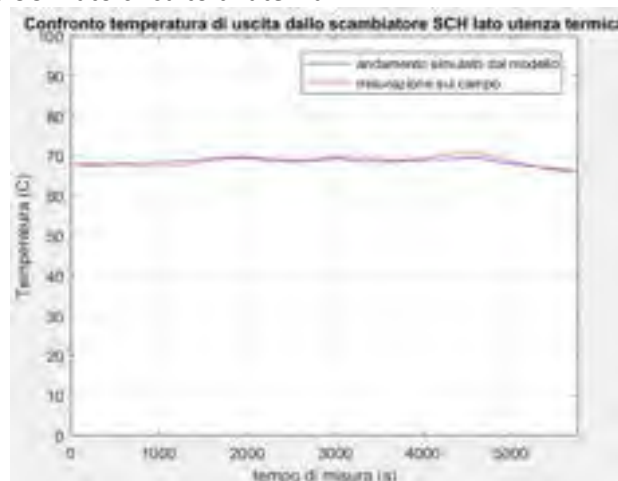
Figura 113: Confronto Temperatura T_{inUSR} prova ST08
