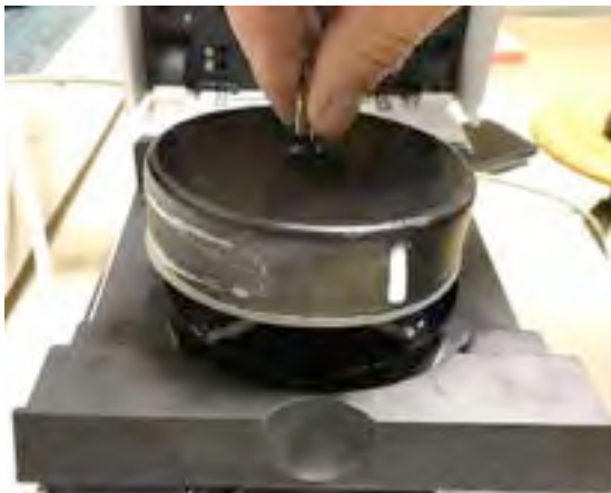
Figura 2.8. (a) Elementi del sistema di contenimento: campana di vetro e piatto metallico; sono visibili il tubo di ingresso (parte frontale) e il tubo in uscita (parte superiore); (b) resistenza termoregolata posizionata nell'intercapedine tra l'ambiente di misura e l'elettronica della bilancia.
