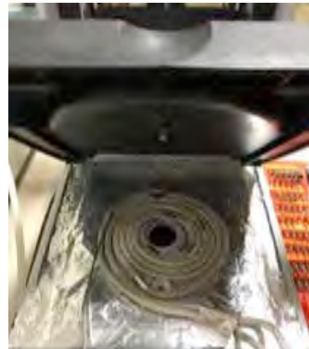
Figura 2.8. (a) Elementi del sistema di contenimento: campana di vetro e piatto metallico; sono visibili il tubo di ingresso (parte frontale) e il tubo in uscita (parte superiore); (b) resistenza termoregolata posizionata nell'intercapedine tra l'ambiente di misura e l'elettronica della bilancia.
