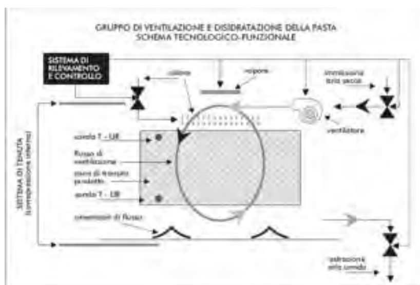
Figura 1. Schema funzionale di un gruppo di ventilazione all'interno di un essiccatore.
