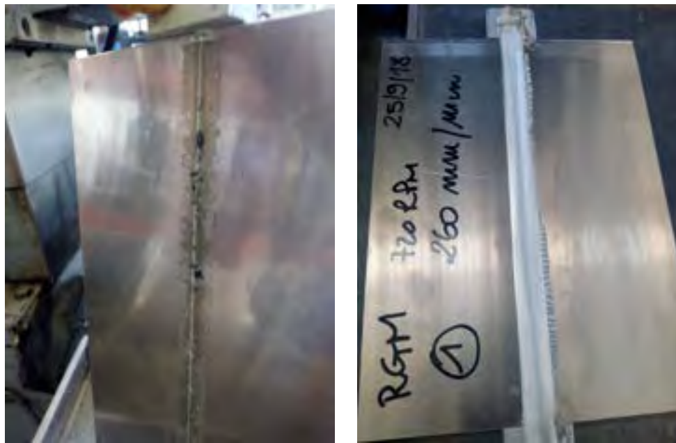
Figura 77 – Piastre saldate dalla Rambaudi Ram-Mill nel corso dei test effettuati
