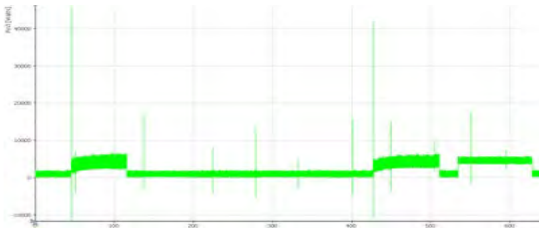
Figura 24 - Potenza assorbita dalla macchina e dal chiller nei diversi test
