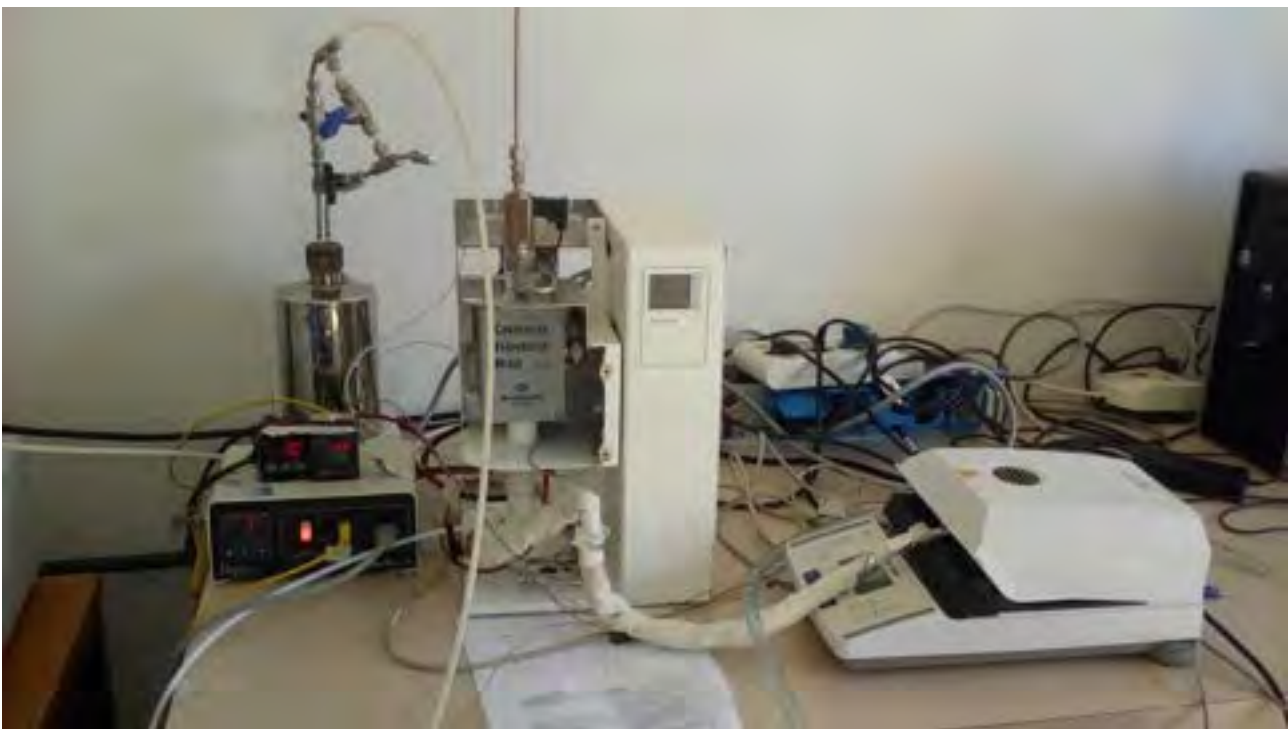
Figura 2.4. Set up sperimentale utilizzato per le misure di adsorbimento e desorbimento di acqua da parte del materiale adsorbente MOF in forma confinata. Il sistema è costituito dall'analizzatore di umidità HB43 Mettler Toledo (a destra, in primo piano) interfacciato con il generatore di vapore VDM (in secondo piano sulla sinistra) per il controllo dell'umidità relativa. Il circuito è riscaldato per mezzo di opportune resistenze controllate e coibentato per evitare la formazione di condensa.
