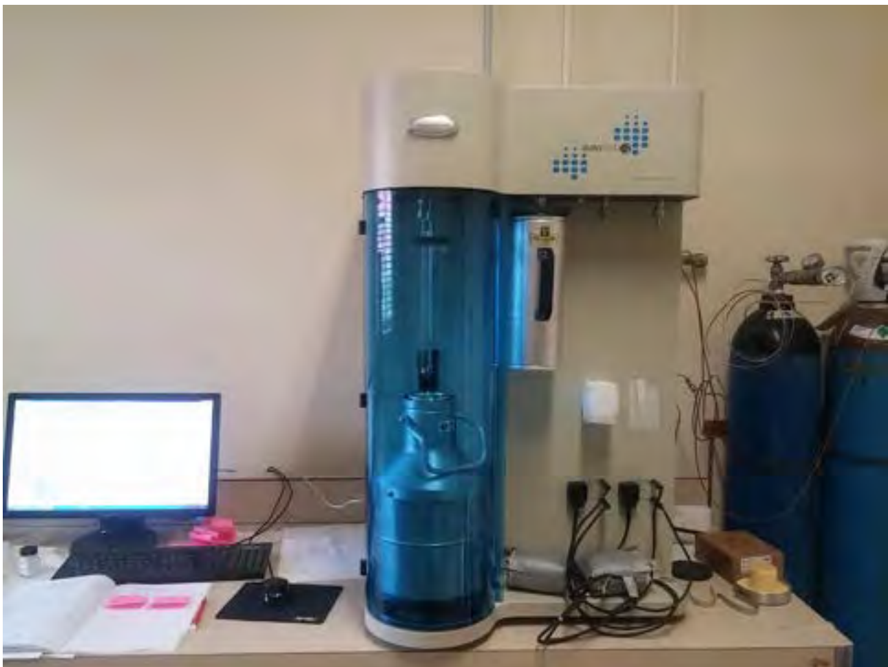
Figura 2.5. Analizzatore di area superficiale e porosità ad alta risoluzione (Autosorb IQ , Quantachrome), utilizzato per le misure di adsorbimento e desorbimento di azoto a 77 K.
