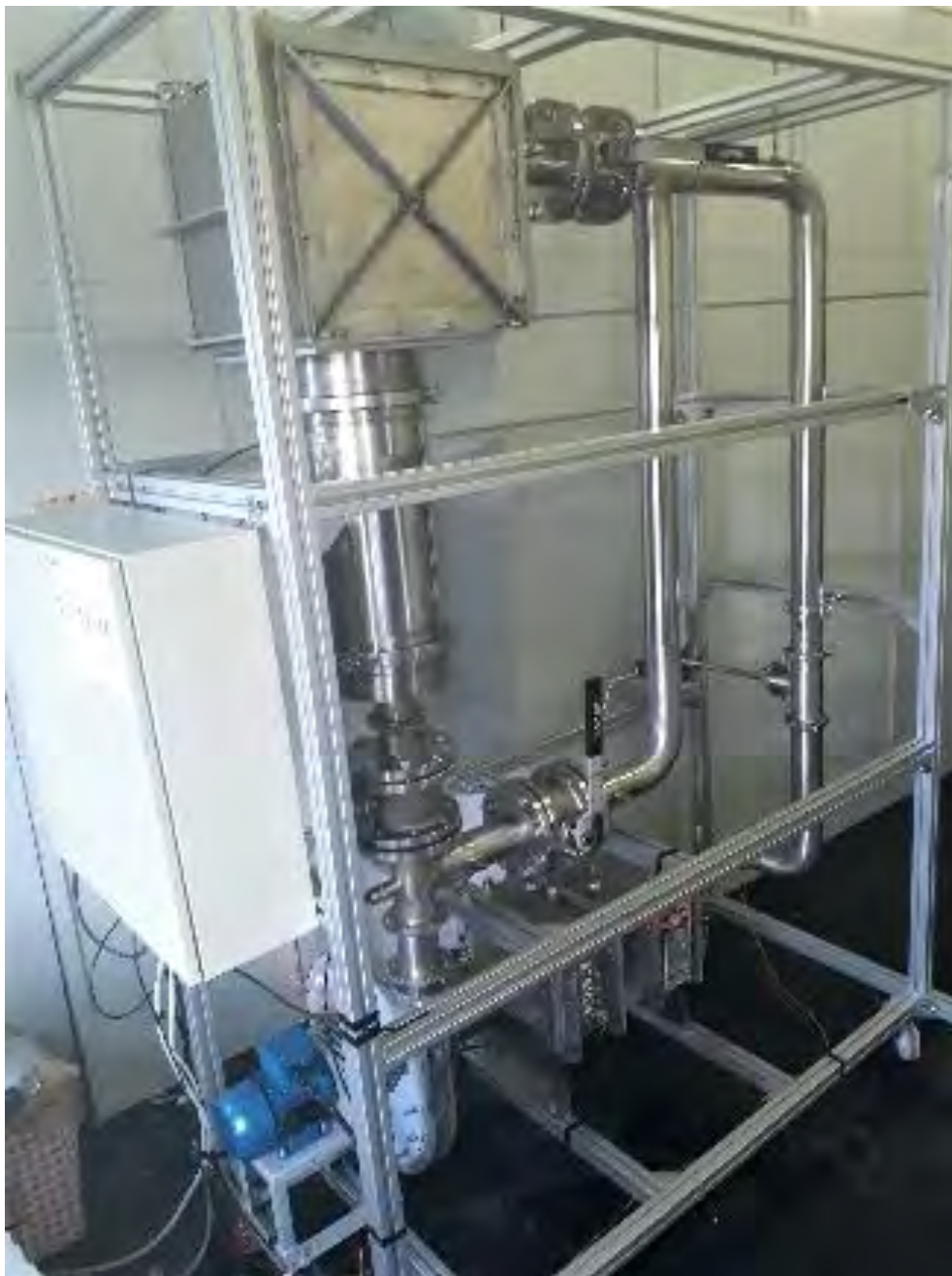
Figura 3.11 Foto del nuovo sistema STEAM rimontato in laboratorio privo di coibentazione.
