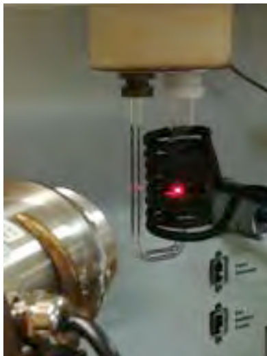
Figura 1. Immagine dell'induttore (diametro= 2.5cm altezza=4.5cm) che circonda il ramo del reattore in quarzo all'interno del quale è inserito il catalizzatore. Un pirometro permette una stima della temperatura raggiunta dal catalizzatore.
