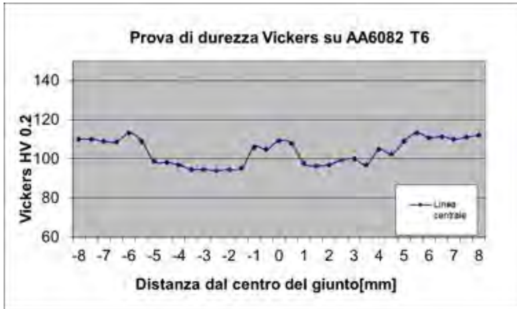
Fig. 11 Mappa delle durezza rilevate sul giunto
