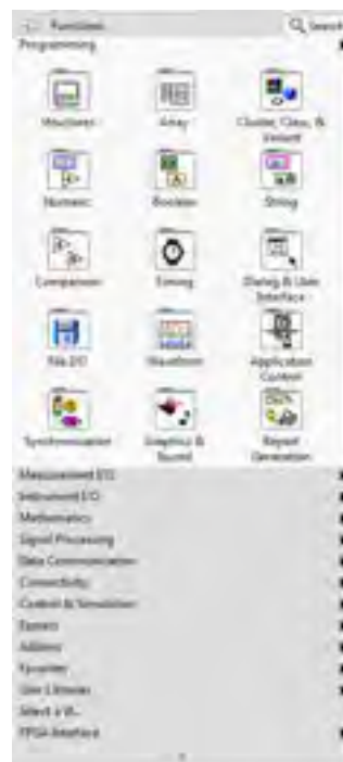
Fig 4 – Functions palette, da utilizzare per inserire functions e subVI nel block diagram.
