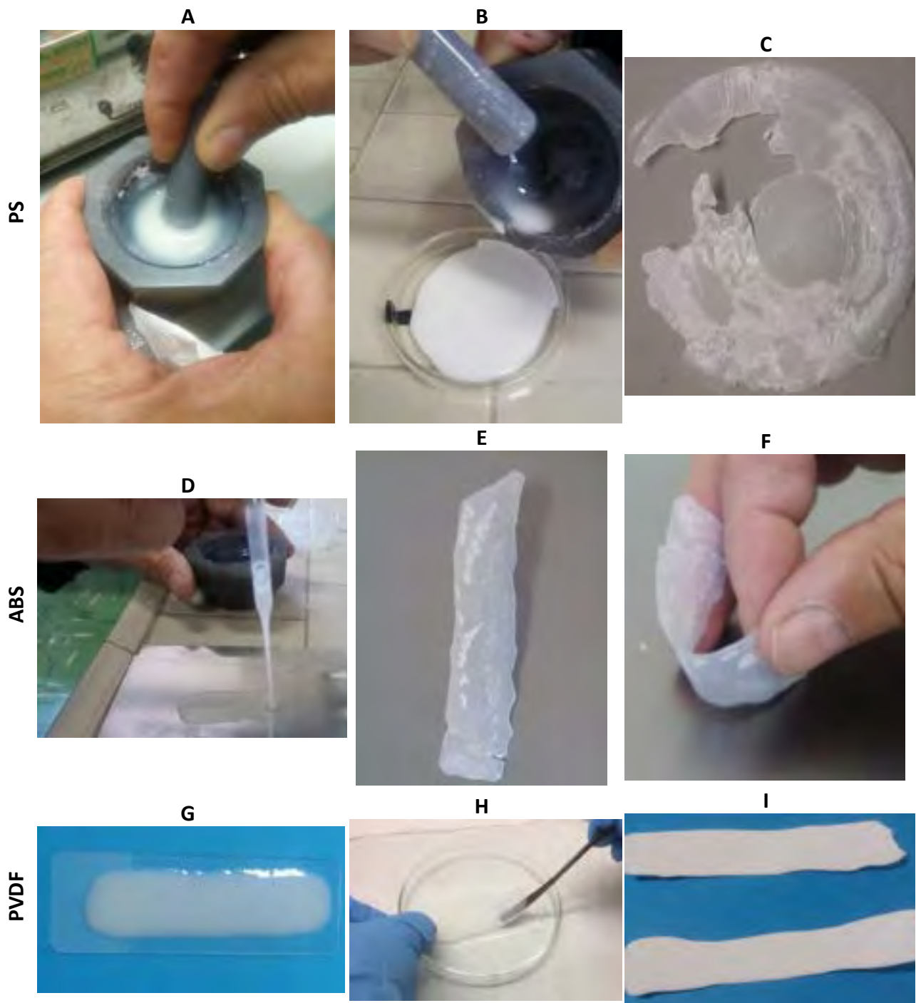
Figura 4. Alcune fasi della preparazione dei compositi polimero/MOF a base di PS: A) dispersione in mortaio; B) casting su vetro; C) rottura del film dopo distacco dovuta a fragilità del PS. ABS: C) casting su alluminio; D) il film è integro dopo distacco; F) il film si flette senza rompersi. PVDF: G) casting su vetro; H) distacco in acetone; I) i film sono omogenei e flessibili.
