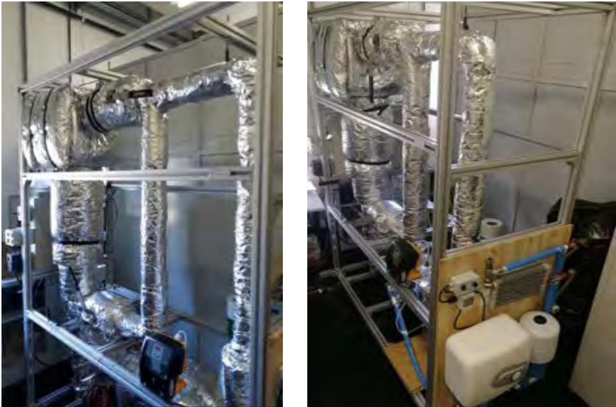
Figura 2.3. Foto del nuovo sistema STEAM approntato in laboratorio con coibentazione (SX) e particolare del sistema di termostatazione dell'acqua di alimentazione del condensatore (DX).
