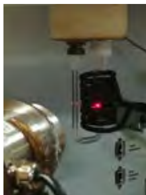
Figura 1. Immagine dell'induttore (diametro= 2.5cm altezza=4.5cm) che circonda il ramo del reattore in quarzo all'interno del quale è inserito il catalizzatore. Un pirometro IR, focalizzato sulla superficie del campione mediante un puntatore laser, permette una stima della temperatura raggiunta dal catalizzatore.
