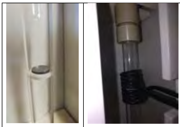
Figura 12. (a) Disco di lega metallica inserito all'interno del reattore in quarzo. (b) il catalizzatore, non visibile, è posto al centro dell'induttore. Le flange del reattore in quarzo sono costruite in kevlar per evitare interazioni con il campo magnetico. Il reattore è confinato all'interno di una scatola di pvc provvista di riscaldamento ad aria (circa 90°C) affinché non si abbia condensa dell'acqua.
