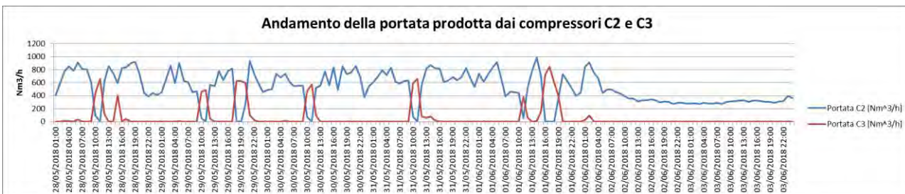
Figura 12: Andamento della portata di aria compressa prodotta dai compressori C2 e C3 nella settimana in esame
