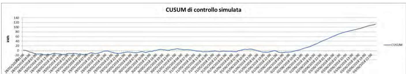
Figura 24: Carta CuSum che simula la situazione di controllo dei consumi nel tempo per il compressore C2
