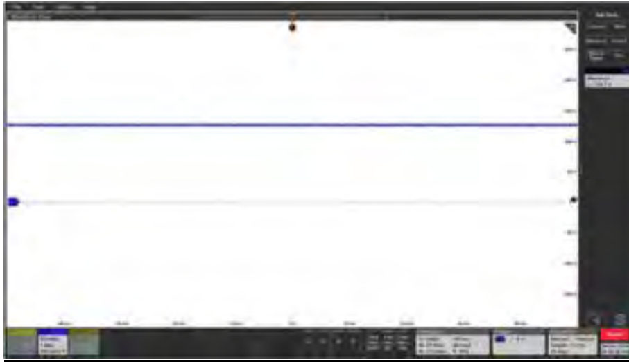
Figura 12. Tensione a vuoto della serie di 10 accumulatori
