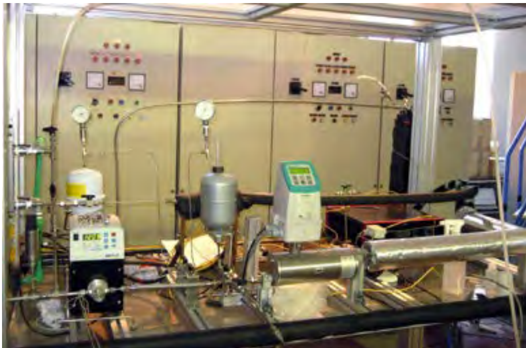
Figura 7 - Impianto HETNA-PCM e, a destra, particolare della sezione di prova
