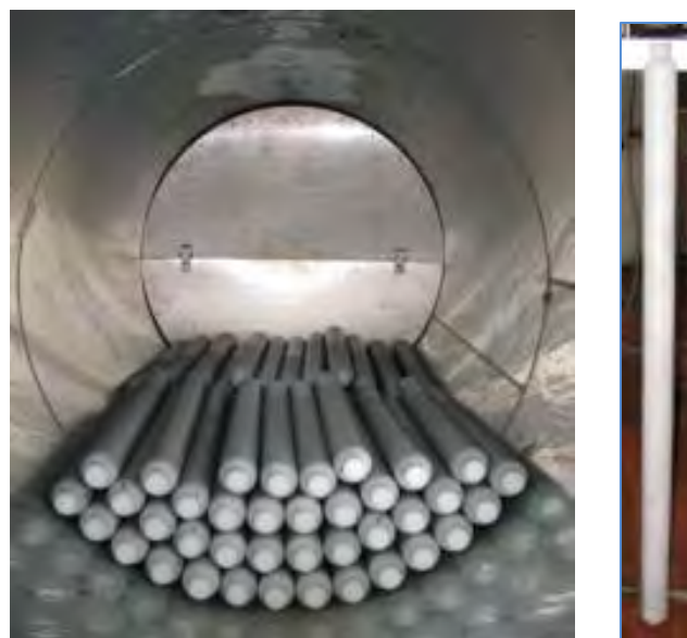
Figura 8 – Serbatoio di accumulo e uno dei contenitori di PCM inseriti in esso.
