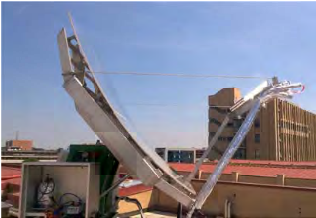
Figura 14 - Collettore solare a concentrazione lineare installato nel Laboratorio di Conversione dell'Energia Solare ed utilizzato per la campagna sperimentale durante questo progetto. Si compone di un'ottica primaria a cilindro parabolico ed un ricevitore con assorbitore a geometria piana.
