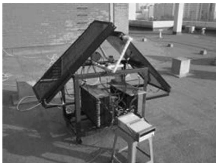
Figura 7. Impianto sperimentale realizzato da Wang et al. [25].
