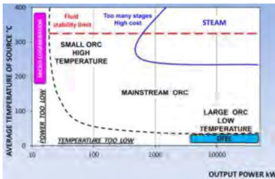
Figura 1. Campi di utilizzo degli ORC al variare della taglia dell'impianto e della temperatura media della sorgente termica [2].
