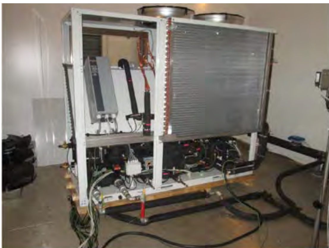
Figura 1. Prototipo di pompa di calore con sistema multi eiettore installato in camera climatica
