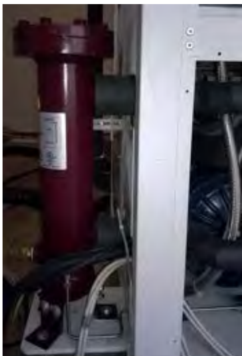
Figura 12. Separatore d'olio (a sinistra) e trasmettitori installati in camera climatica (a destra)
