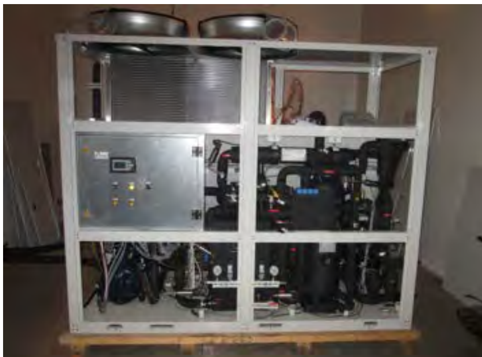
Figura 20. Prototipo di pompa di calore reversibile da 30 kW (prima dell'inserimento del separatore d'olio)
