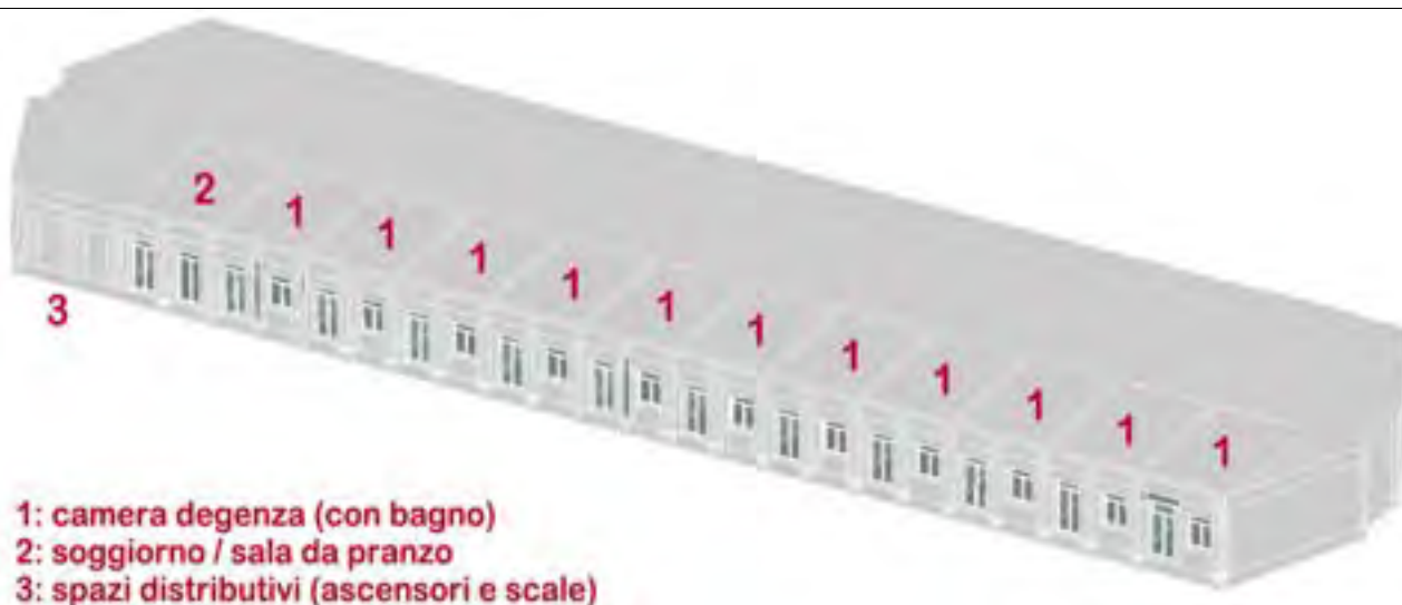
Schema degli ambienti esposti a Est (camere degenza, soggiorno comune, blocco scale/ascensori) e delle relative superfici finestrate.
