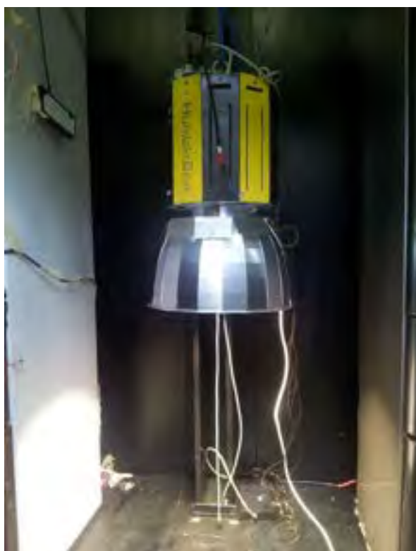
Figura 22 - L'apparecchio HumbleBee con riflettore Almemo, in prova nella camera climatica
