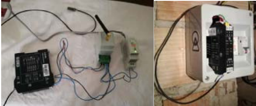
Figura 12- Componenti del kit per la misura del gas APIO e sua installazione nell'abitazione 4
