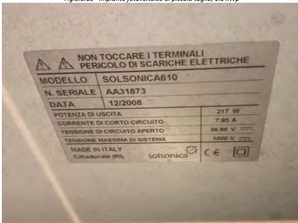
Fig.3.3.14 – Dati di targa dei pannelli fotovoltaici
