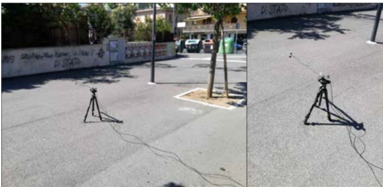
Figura 7: Albedometro in fase di misura nella Piazza dei Mirti.
