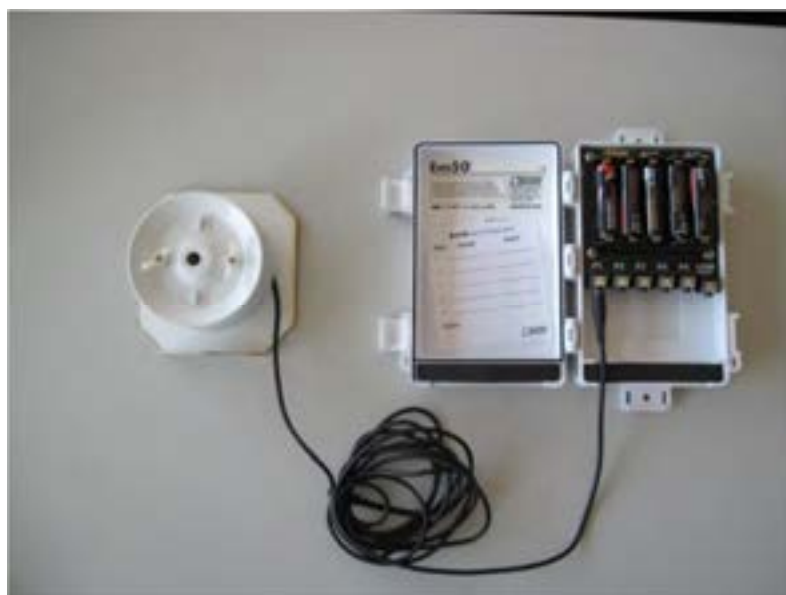
Figura 4: Termo-Igrometro (sinistra) e scheda di acquisizione.
