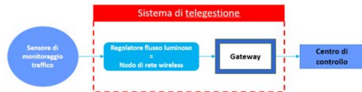
Figura 10: Schematizzazione semplificata dell'impianto di "Monitoraggio del traffico" + sistema di trasmissione wireless creato dal sistema di telegestione integrato nell'infrastruttura di Pubblica Illuminazione
