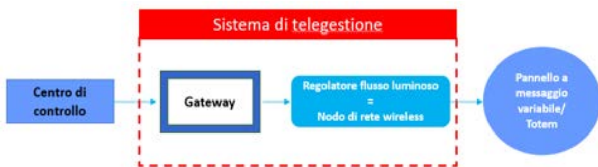
Figura 14: Schematizzazione semplificata dell'impianto di "Pannelli informativi a messaggio variabile/Totem" + sistema di trasmissione wireless creato dal sistema di telegestione integrato nell'infrastruttura di Pubblica Illuminazione
