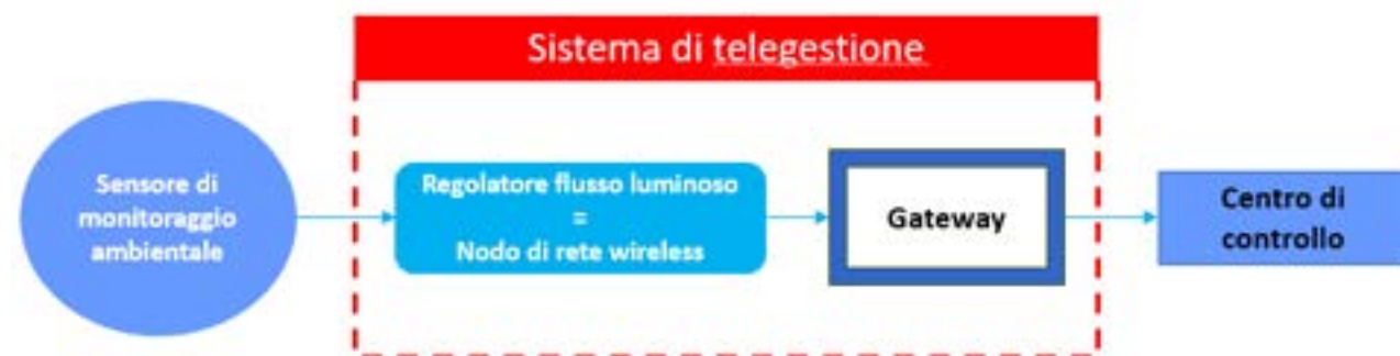
Figura 12: Schematizzazione semplificata dell'impianto di "Monitoraggio ambientale" + sistema di trasmissione wireless creato dal sistema di telegestione integrato nell'infrastruttura di Pubblica Illuminazione
