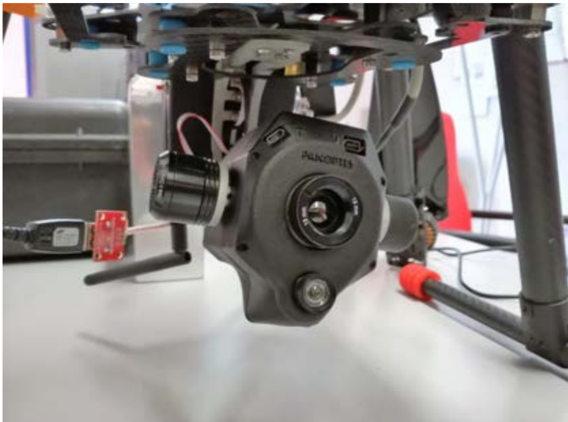
Figura 7. Il payload video: il sensore 'Panoptes' una termocamera sovrapposta ad una videocamera HD
