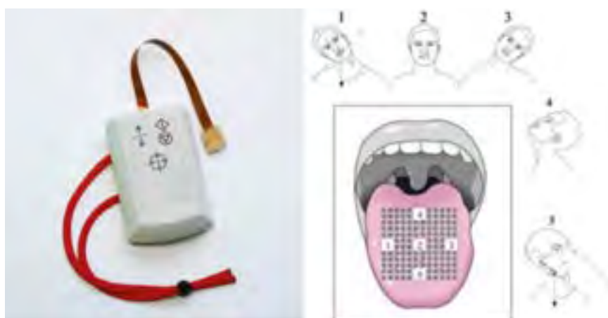
Figura 15. Esempio di stimolazione tattile applicata alla lingua per fornire un feedback sull'inclinazione della testa in soggetti con perdita di equilibrio vestibolare. [22].
