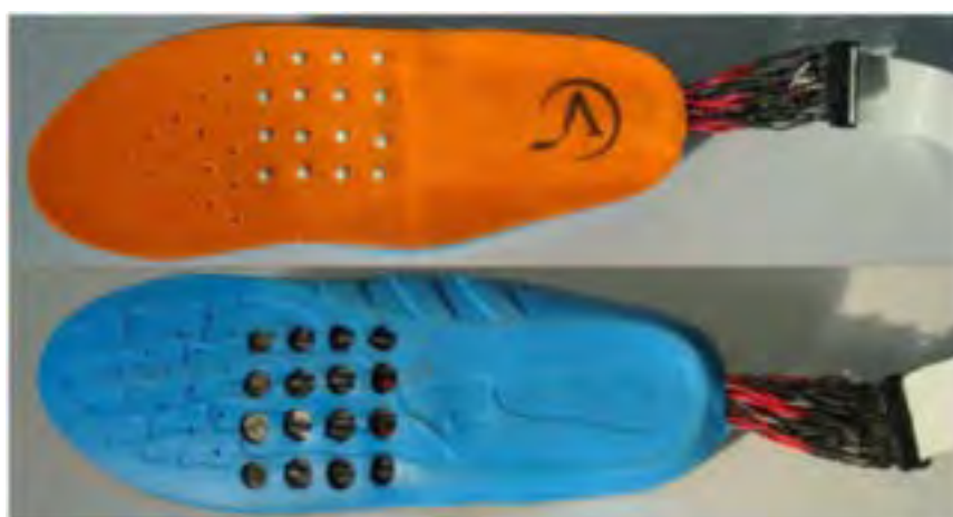
Figura 14. Solette con dispositivi di vibrazione per supporto alla deambulazione per i non vedenti. [22].
