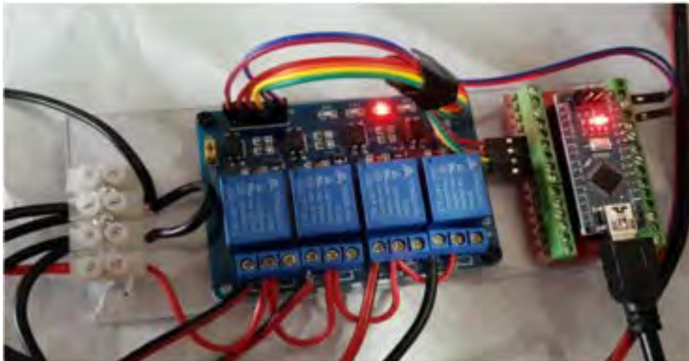
Figura 121: Primo prototipo costituito da 4 relè per il controllo della ventola, del rivoltamento, dell'inversione di rotazione e della resistenza riscaldante
