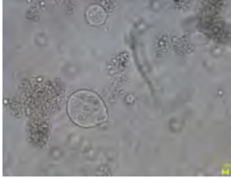
Figura 19 Focchi di fango, con ciliati sessili, contrasto di fase, ingrandimento 250x
