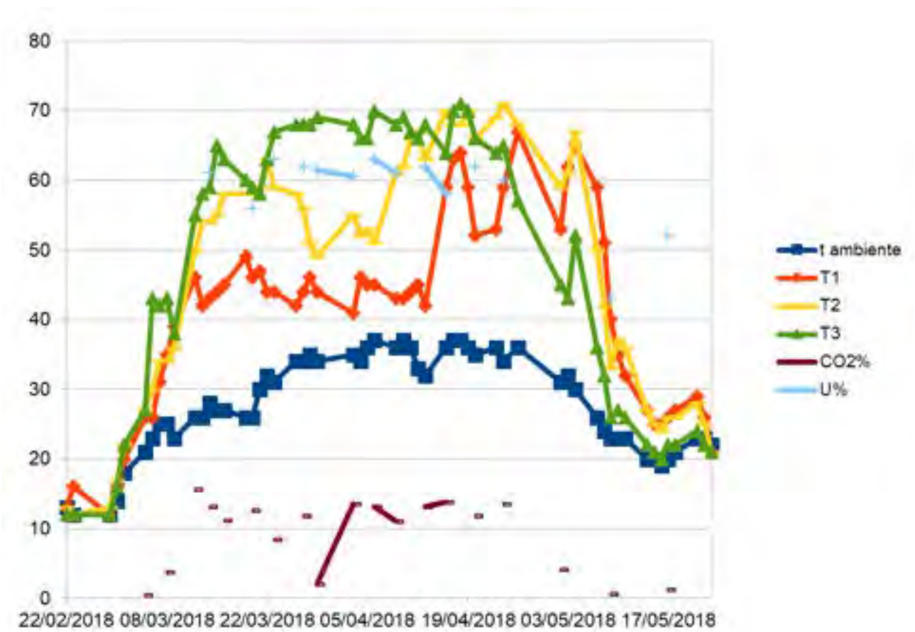
Figura 127: Andamento parametri compostiera elettromeccanica
