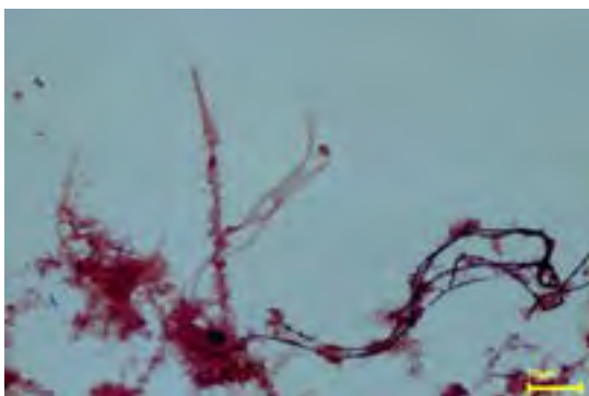
Figura 23 Flocchi di fango con microrganismo filamentoso Microthrix parvicella , evidenziato dalla colorazione di Gram. Il microrganismo e' Gram + (filamenti scuri) DIC, ingrandimento 1000X
