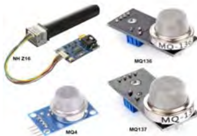
Figura 119: Sensori adottati per la concentrazione dei gas in emissione
