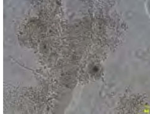
Figura 20 Focchi di fango con batteri filamentosi, contrasto di fase, ingrandimento 250x
