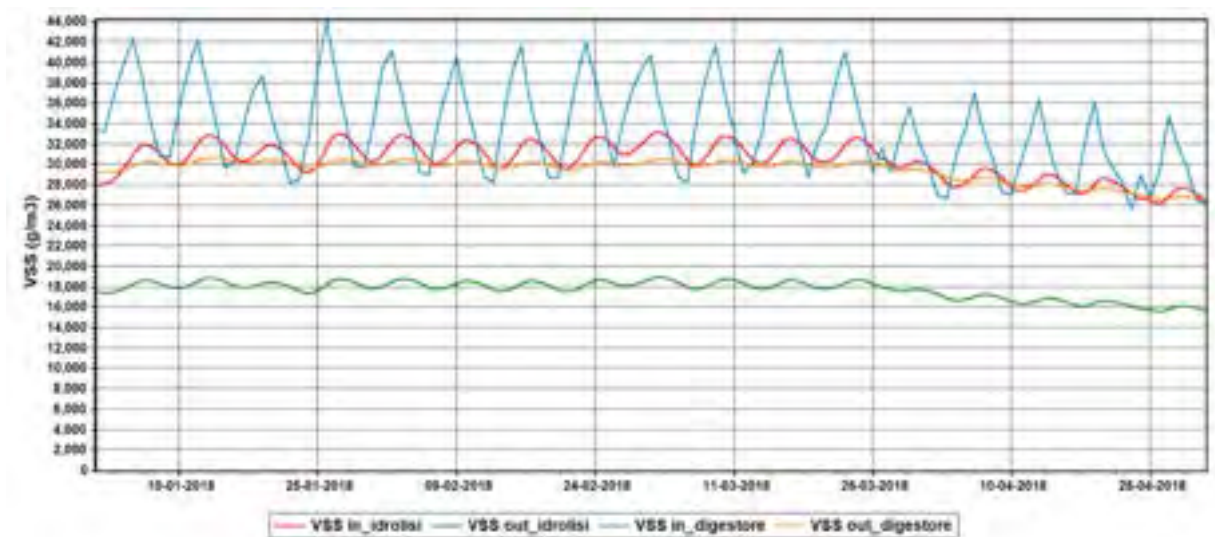
Figura 46. Rimozione dei solidi volatili nel trattamento di idrolisi termica e digestione anaerobica – Scenario EFF5
