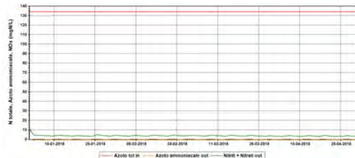
Figura 18. Andamento della concentrazione dell'azoto (in ingresso) e dell'azoto ammoniacale e nitriti+nitrati (in uscita) dall'impianto per i 120 giorni di simulazione_Scenario 0
