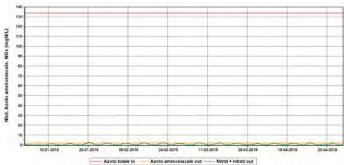
Figura 42. Andamento della concentrazione dell'azoto totale in ingresso e delle diverse forme azotate in uscita per i 120 giorni di simulazione – Scenario EFF4
