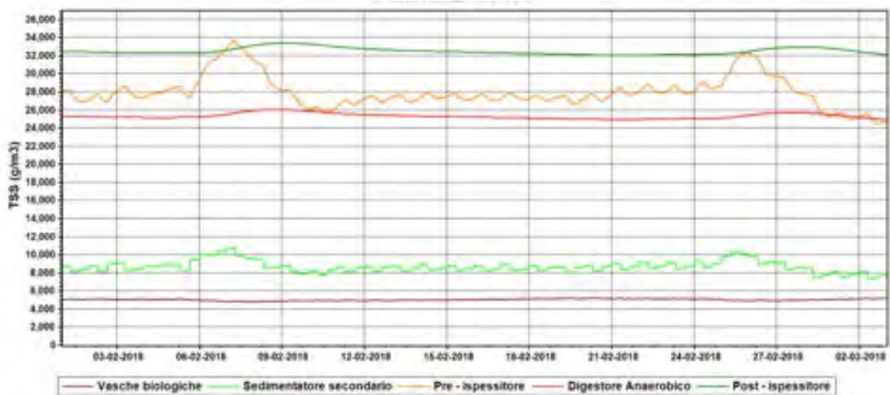
Figura 8. Andamento mensile della concentrazione dei solidi per la linea fanghi
