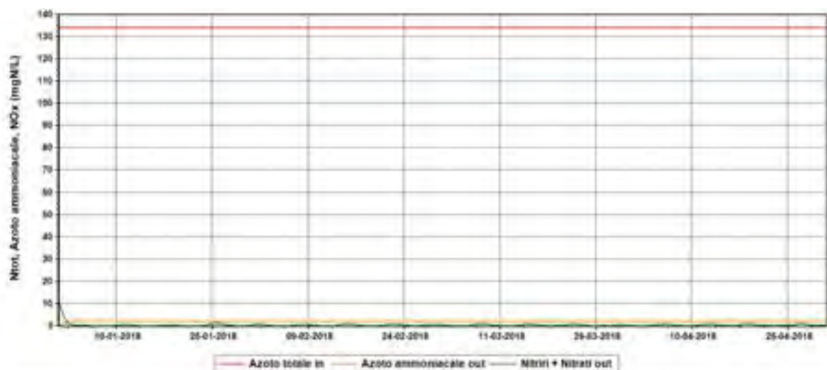
Figura 29. Andamento della concentrazione dell'azoto totale in ingresso e delle diverse forme azotate in uscita per i 120 giorni di simulazione – Scenario EFF1
