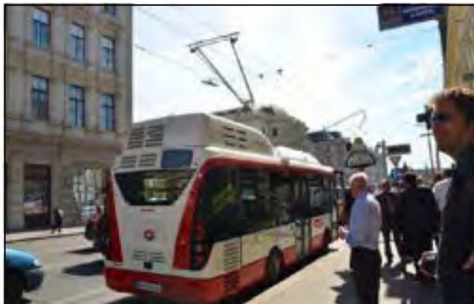
Figura 11: Esempio di ricarica con collegamento pantografo a catenaria (autobus ALè a Vienna) Fonte: RAMPINI
