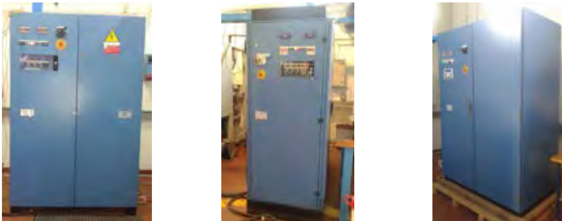
Figura 2. Ciclatori utilizzati per l'esecuzione delle prove: E-8094 (sinistra), E-8376 (centro), E-8619 (destra)
