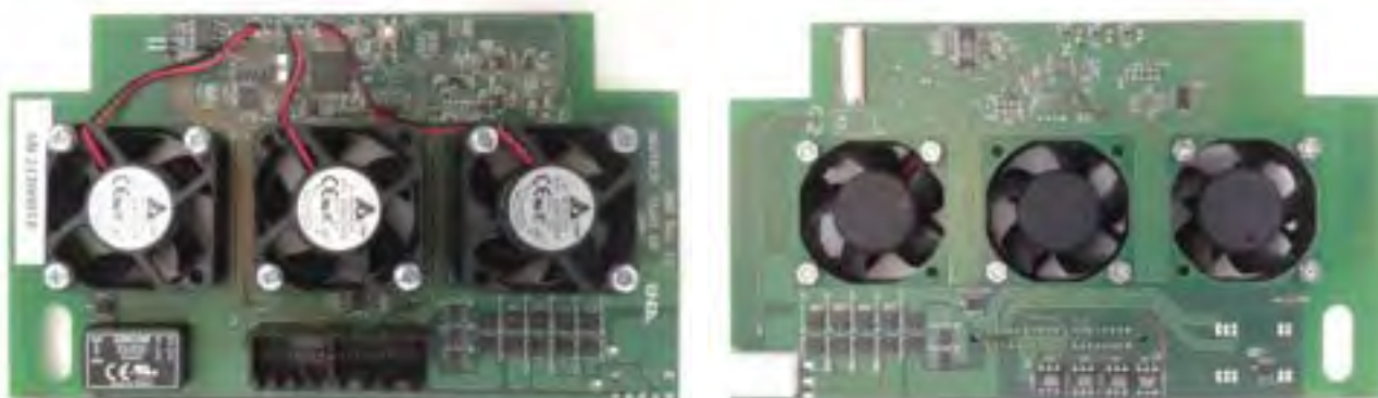
Figura 5. Scheda elettronica BMS, lato superiore (sinistra) e lato inferiore (destra)
