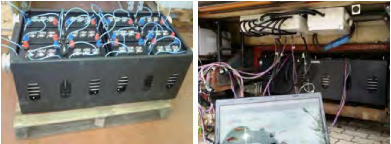
Figura 8. Vano porta batteria completo di 12 moduli (sinistra) e sua installazione a bordo del minibus (destra)
