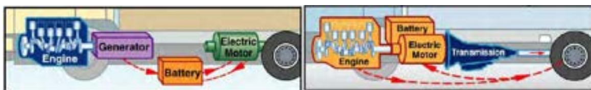
Figura 2: Configurazione ibrido in serie e in parallelo
