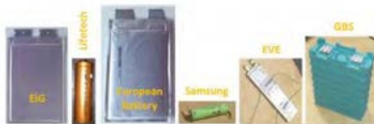
Figura 15. Foto delle celle analizzate.
