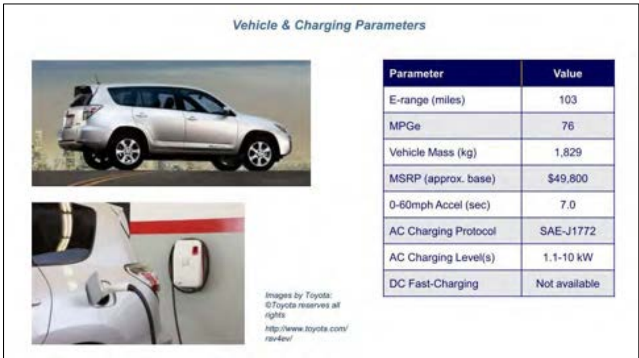
Figura 47. Veicolo e parametri di ricarica (Fonte: Total Battery Consulting) [22]
