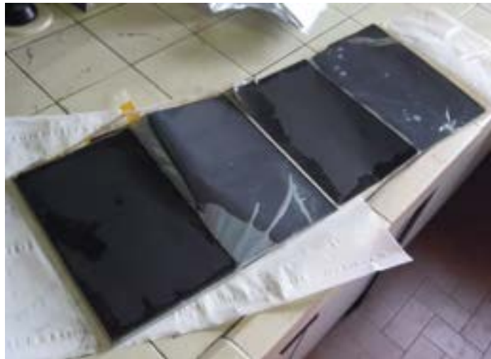
Figura 9. Struttura interna di una cella EIG C020 (Foto: Carla Menale 7 )
