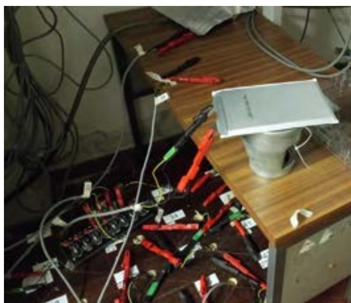
Figura 1 Procedura di scarica della cella vergine EiG modello C020.
