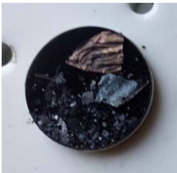
Figura 26 Residui batteria incendiata, campione 3.
