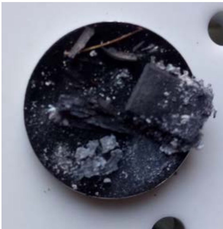
Figura 21. Residui batteria incendiata, campione 2.
