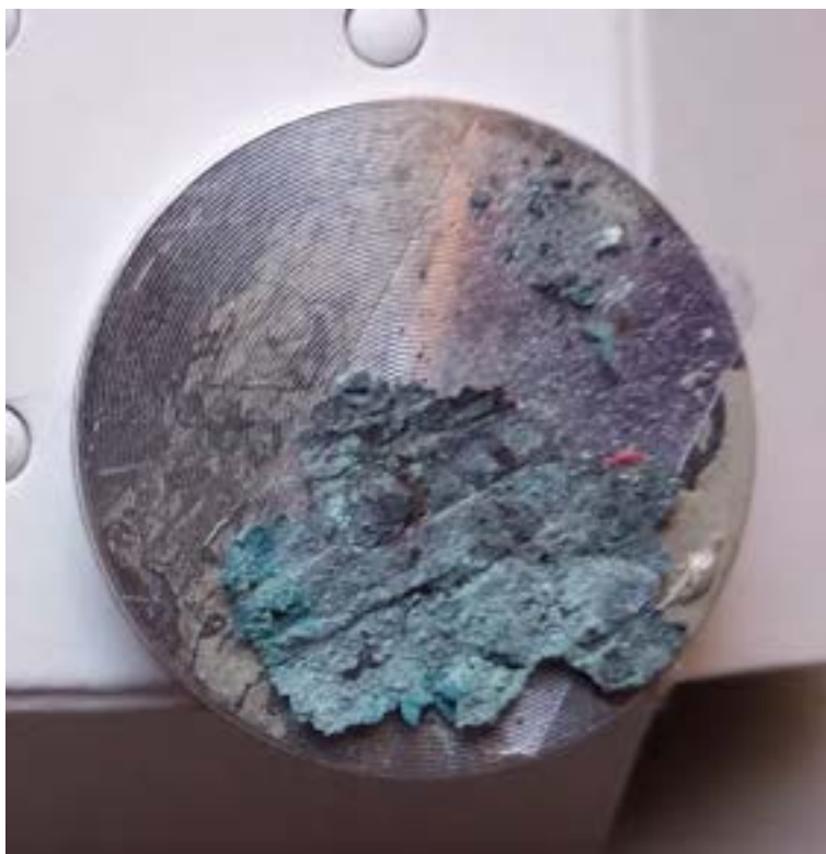
Figura 18 Residui di una batteria incendiata, campione 1.
