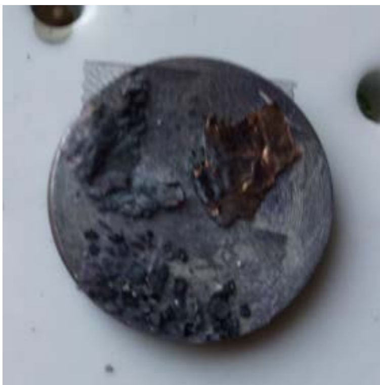
Figura 31 Residui batteria incendiata, campione 4.
