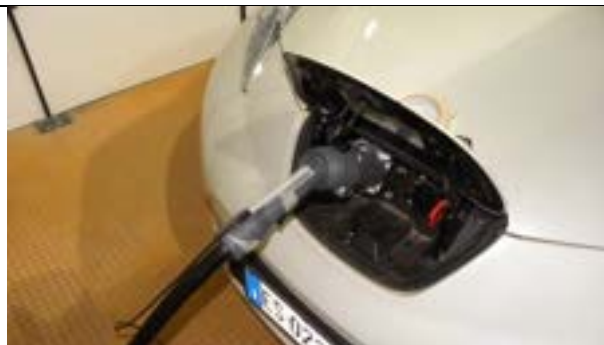
Figura 54 – Punto di misura sul connettore CHAdeMO (manipolo) a 3.5 m dall'uscita del pannello
