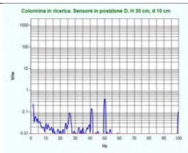
Figura 42 – Misura della componente spettrale a 50 Hz del campo elettrico sul punto di massimo
