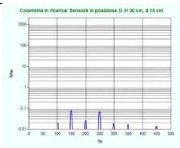
Figura 43 – Misura delle componenti spettrali tra 100 Hz e 500 Hz del campo elettrico sul punto di massimo
