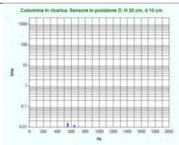
Figura 44 – Misura delle componenti spettrali tra 500 Hz e 2 kHz del campo elettrico sul punto di massimo
