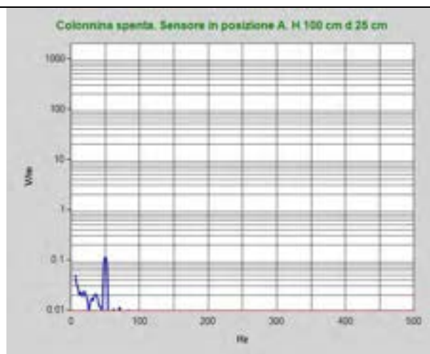
Figura 13 – Campo elettrico SPAN 500 Hz
