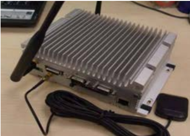
Figura 12 Computer Embedded per impieghi industriali con varie antenne esterne collegate (Wi-Fi, GPS, GPRS/UMTS)
