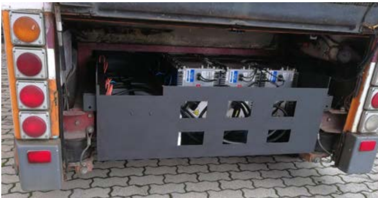
Figura 16 il cassone installato a bordo del bus laboratorio
