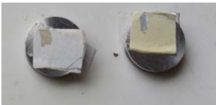
Figura 14 Separatore polimerico della cella vergine Panasonic NCR 18650B (PR). Sulla sinistra il lato ricoperto da uno strato di elettrolita (in bianco).
