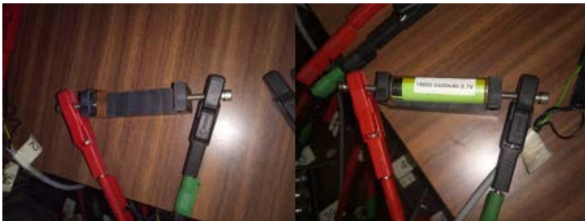
Figura 1 Dispositivo di alloggiamento realizzato per la scarica delle celle Panasonic NCR 18650.
