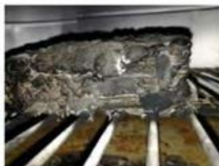
Figura 12. Esposizione a fiamma del modulo Thundersky dopo cortocircuito [4] (v. figura 11)
