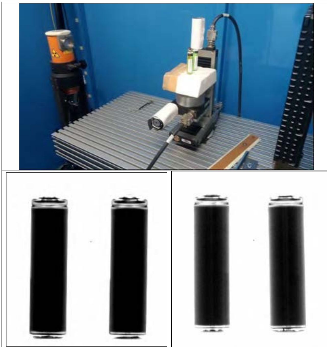
Figura 34. Panasonic 18650B protetta. A sinistra: 90 KV, 1mA. A destra: 90 KV, 1mA e 90°
