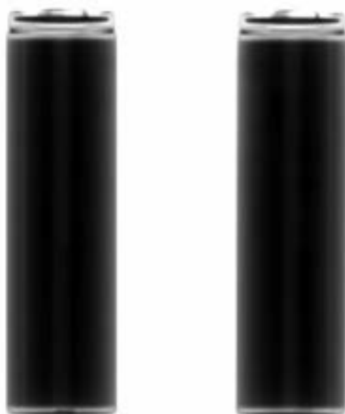
Figura 37. PANASONIC 18650 BM non protetta. 90 KV 1mA 4
