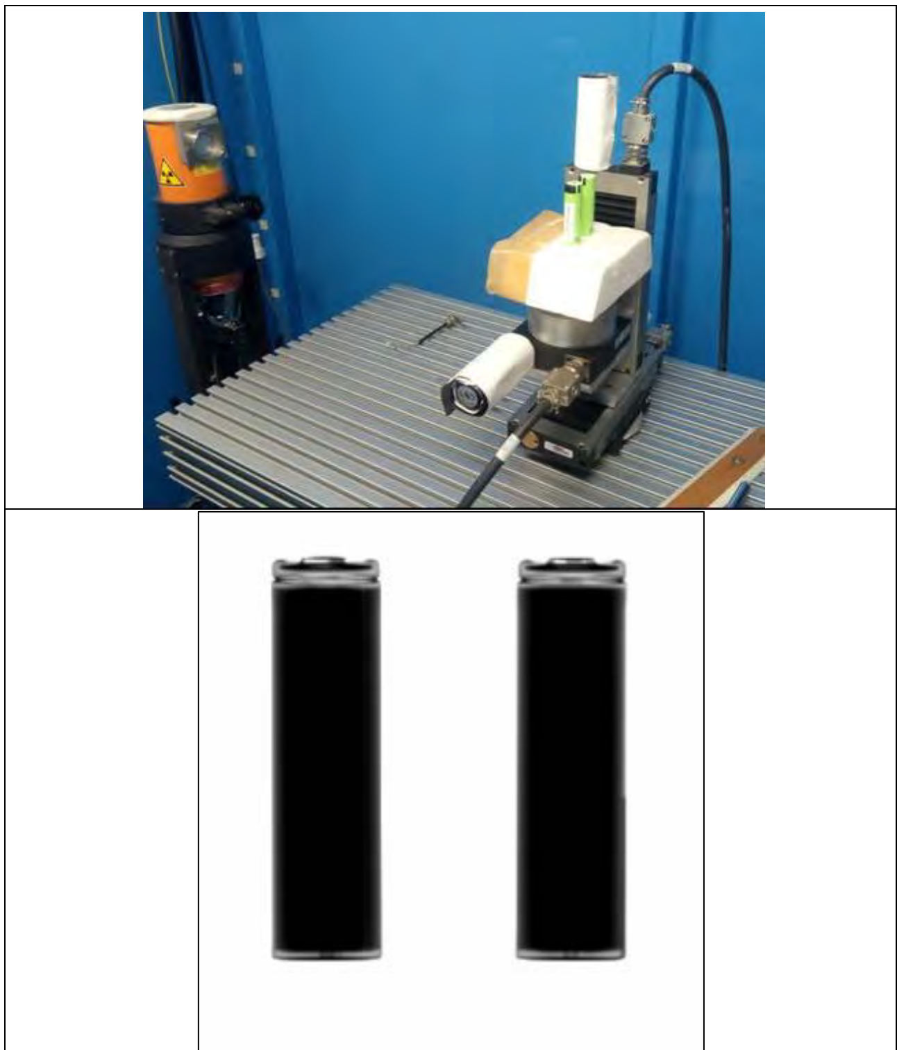
Figura 35. Panasonic 18650B NON protetta; 90 KV, 1mA
