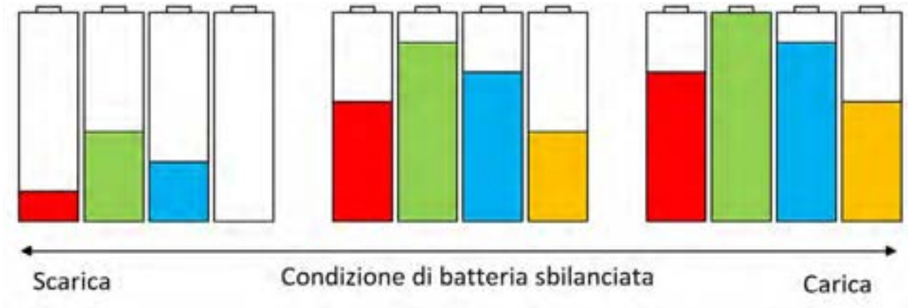
Figura 2 – Effetti dello sbilanciamento sulla massima carica estraibile in condizioni ideali (capacità reale uguale alla capacità nominale).
