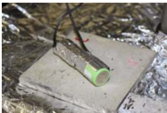
Particolare del campione con le termocoppie
