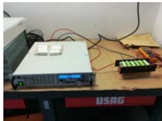
Fig. 5 – Sistema per la ricarica delle celle con carico elettronico.
