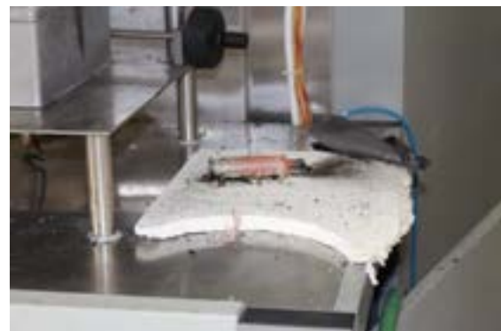
Aspetto del campione subito dopo l'esplosione; 148 s
