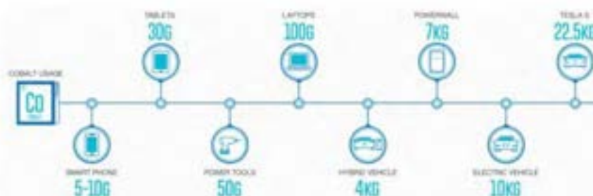
Figura 21: Alcuni usi del cobalto nell'elettronica e nei veicoli elettrici con le rispettive quantità utilizzate
