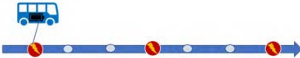
Figura 1. Schema di una architettura di ricarica flash alla fermata per mezzi di trasporto pubblico urbani.
