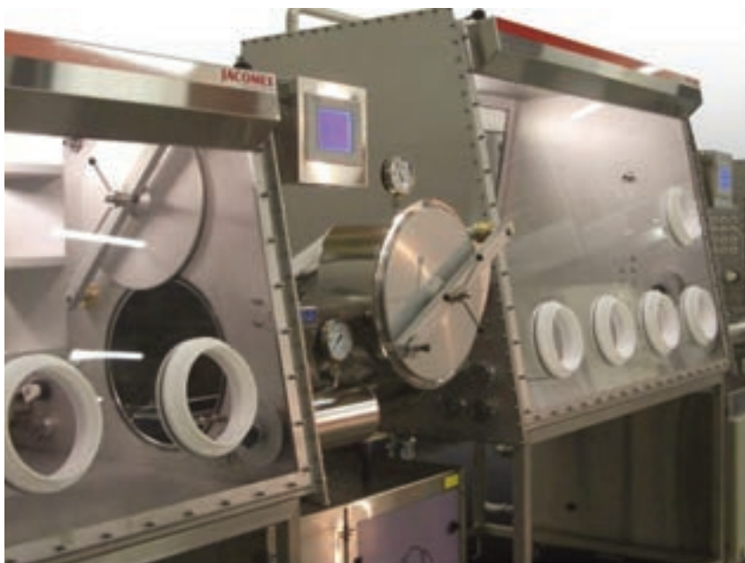
Glove Box per lo sviluppo di celle solari polimeriche in ambiente privo di umidità e ossigeno
