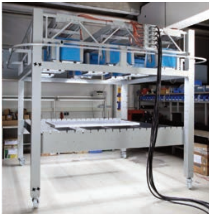
Attrezzatura per il light-soaking di moduli e dispositivi a film sottile con tecnica VHF-PECVD
