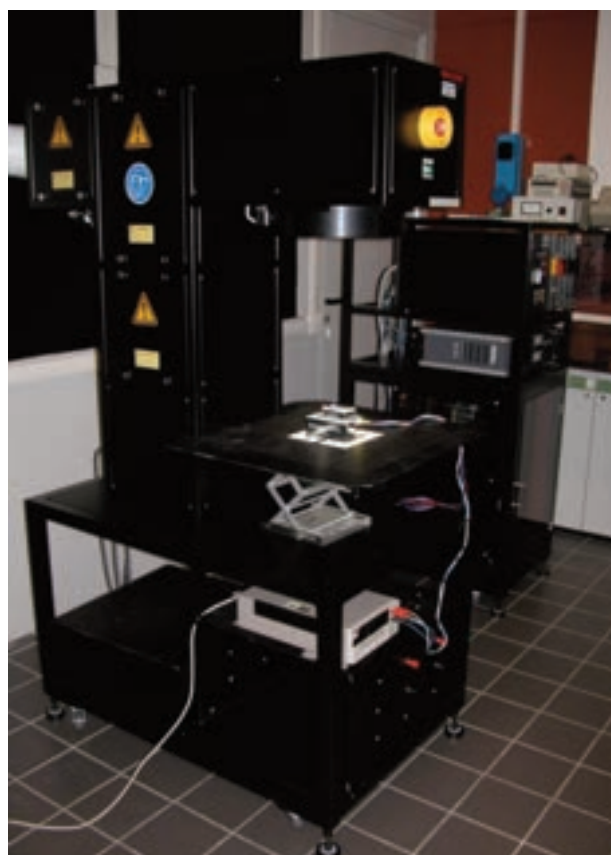
Simulatore solare a doppia sorgente (Xe, Alogena) per la corretta valutazione delle prestazioni di celle tandem micromorfe a film sottile di silicio
