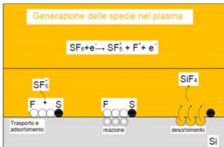
Figura 2. Schematizzazione del processo RIE
