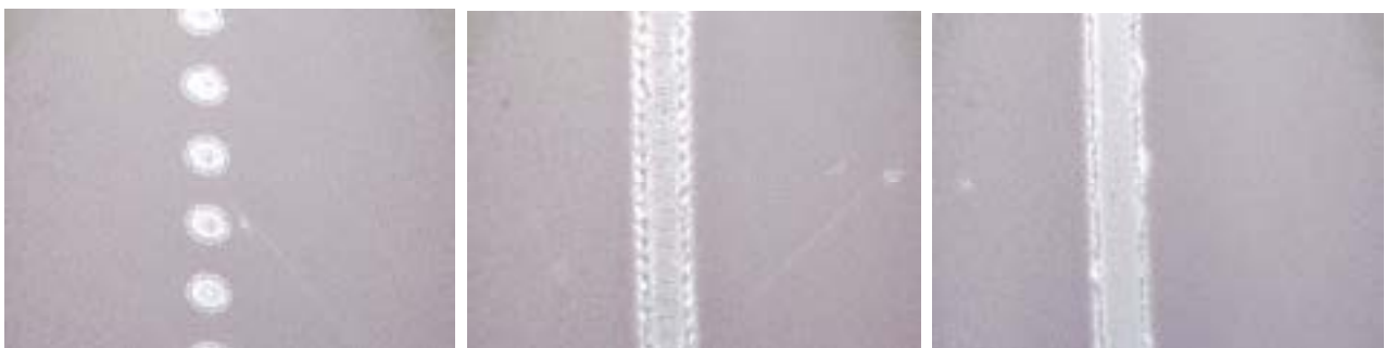
Fig. 5: Aumento graduale della sovrapposizione degli spot all'aumentare della frequenza di ripetizione (1000 Hz, 4000 Hz, 7000 Hz). I tagli sono stati eseguiti utilizzando una intensità di corrente pari a 13.00 A, una velocità di avanzamento pari a 80 mm/s e un'altezza del fuoco pari a 0.80 mm.
