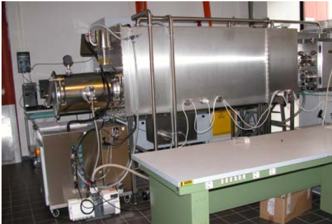
Foto del sistema glove box con evaporatore termico installato nel Laboratorio Celle Fotovoltaiche Polimeriche .
