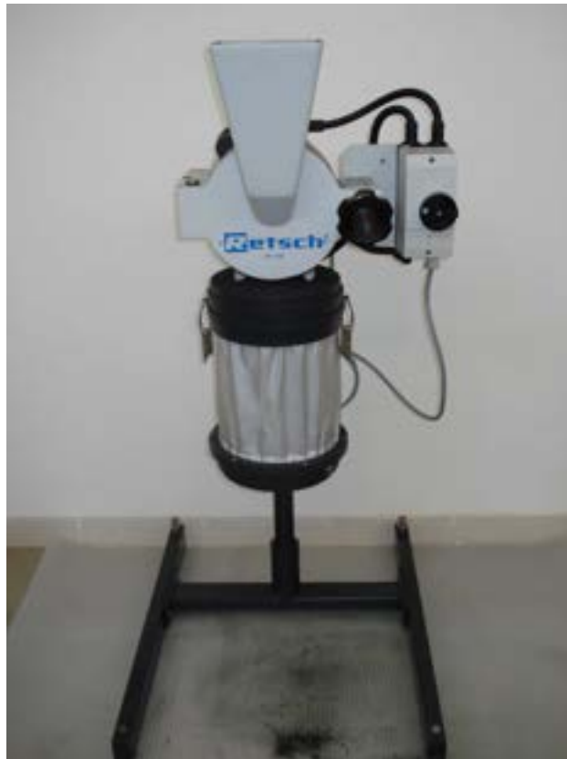
Fig. 2 – Mulino a croce modello SK 100
