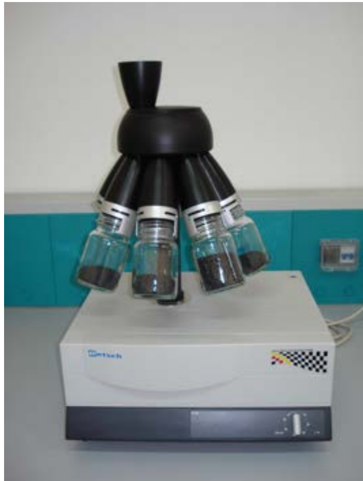
Fig. 4 – Ripartitore da laboratorio modello PT 100
