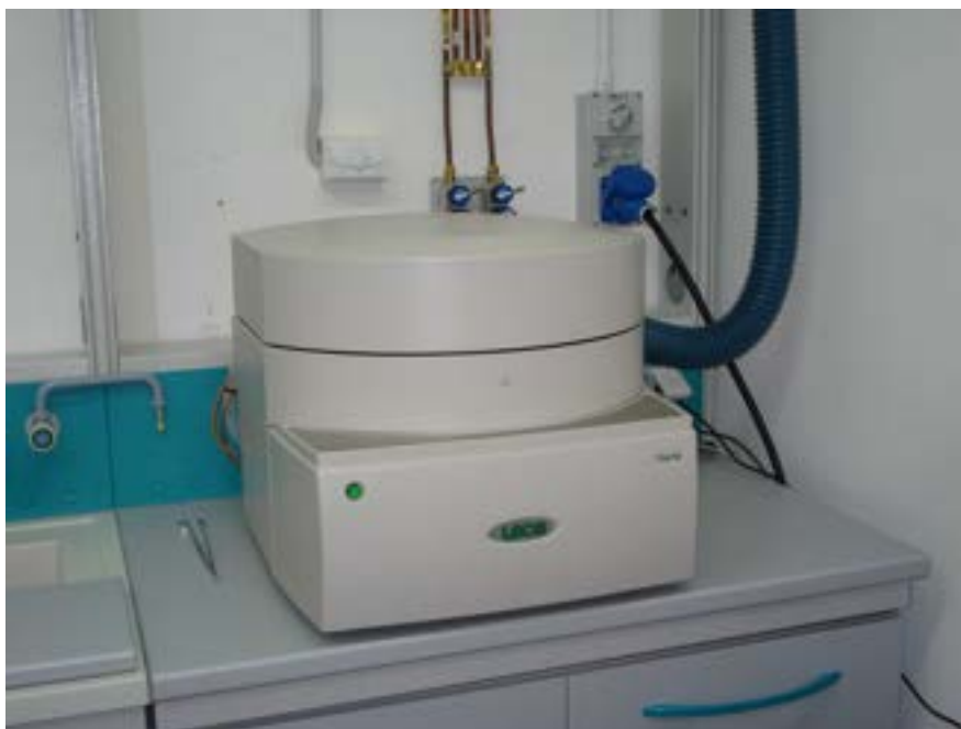
Fig. 6 – Analizzatore termogravimetrico TGA-701 Leco
