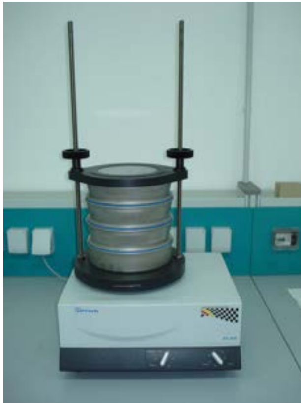
Fig. 3 – Setacciatrice da laboratorio modello AS 200
