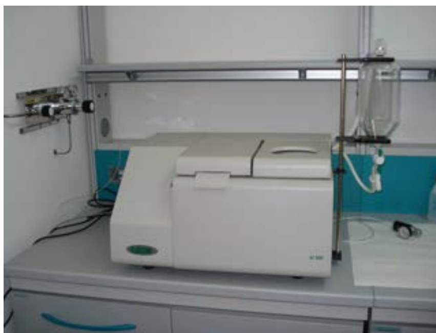
Fig. 7 – Calorimetro isoperibolico AC-500 Leco
