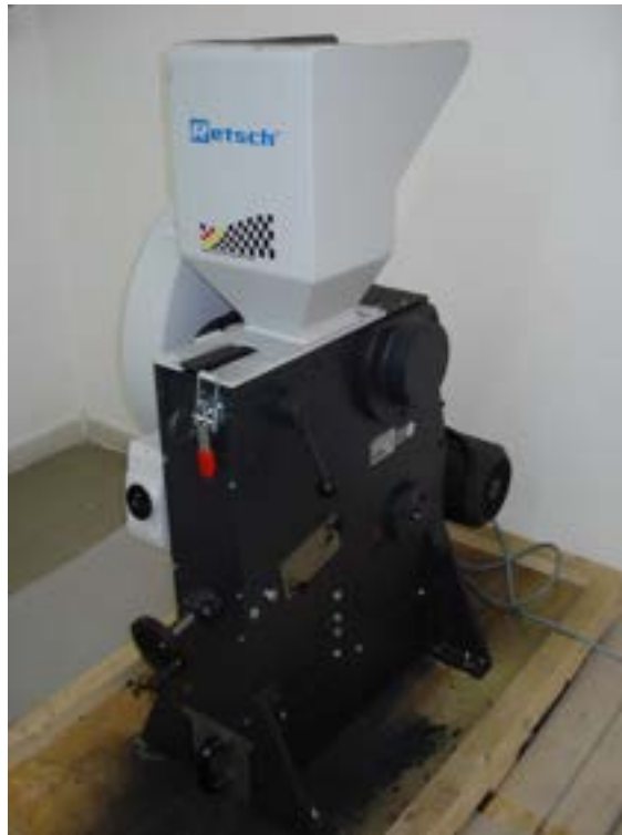
Fig. 1 - Frantoio a mascelle con ganasce Retsch, modello BB 200
